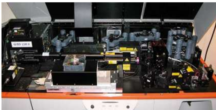
图2 由波长不连续的 8 个激光器组成的高标准流式细胞术工作台完全可以通过一台超连续激光器来取代。
